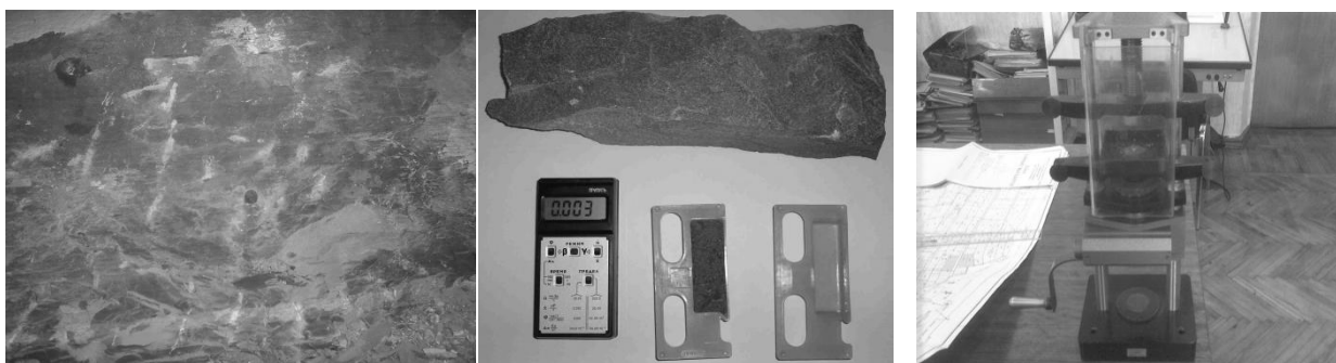
Рис. 3. – Обследования слоя песчаника неимоверной крепости и высочайшей абразивности
