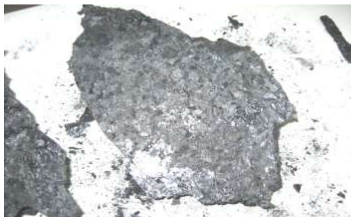
Рис. 6 – Межслоевая поверхность угля пласта m_3 покрыта фюзеном
