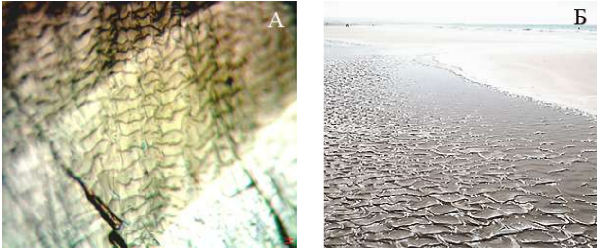
Рис. 17 – А) микроструктура межслоевой поверхности угля пласта l_4 , изображенной на рисунке 15; Б) прибрежно – морская поверхность
