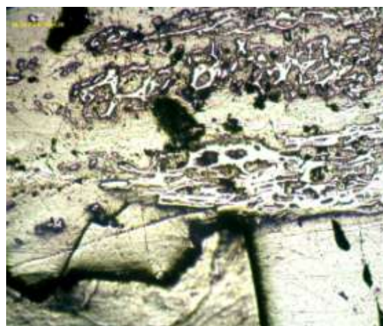
Рис. 9 – (а) уголь пласта l_4 состоит из гелифицированного вещества ( Vt - 87 %), включающего микрокомпоненты липтинита; (б) уголь пласта m_3 состоит из гелифицированного вещества ( Vt -83 %), включающего хрупкие микрокомпоненты инертинита
