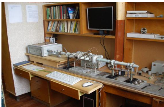
Рис. 15. Экспериментальный макет МКП для измерения ДОР объектов в частотной области 0,17-0,22 ТГц при различных поляризациях
