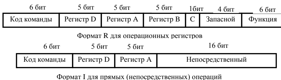
РИС. 3. Форматы арифметико-логических команд скалярного DIVA
