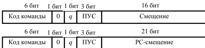
РИС. 6. Базовые форматы команд ветвления гипотетической РИМ-системы
