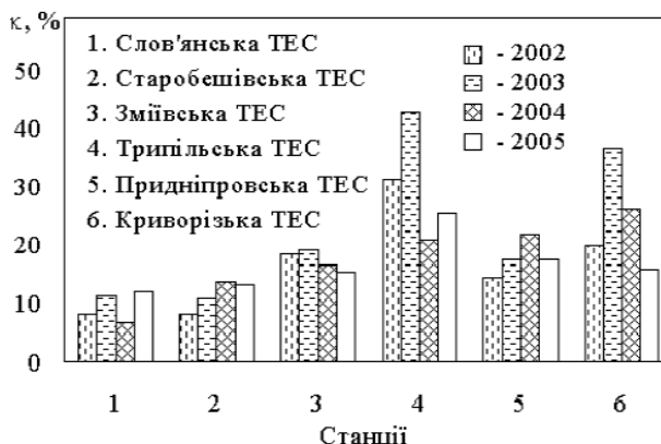
Рис. 1. Витрати газомазутного палива на підсвічування факела
