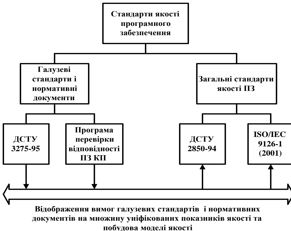
Рис. 4. Діаграма відображення характеристик якості галузевих стандартів на множину характеристик загальних стандартів з якості ПЗ
