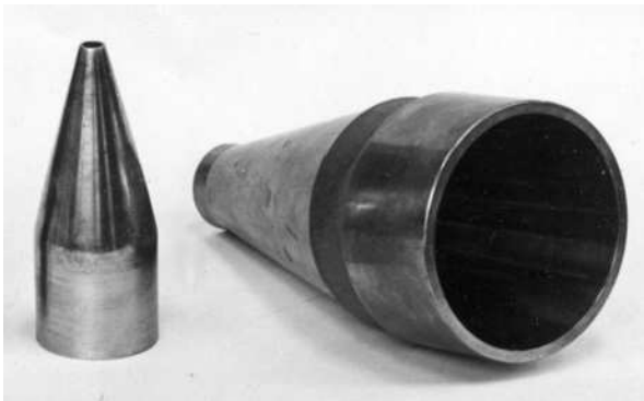
Рис. 1. Параболоїдний односторонній концентратор: а – схема; б – фото
