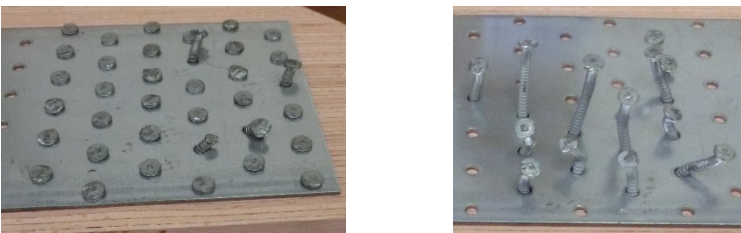
Bild 4-3: Vergleich von Einschlagversuchen von Rillennägeln 4,0 \times 35 \text{ mm} ( links ) und 4,0 \times 50 \text{ mm} ( rechts ).
