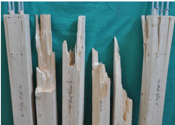
Bild 5-1 Prüfkörper mit faserparallel eingeklebten Gewindestangen nach der Versuchsdurchführung mit erzieltm Versagen im Brutto- bzw. Nettoquerschnitt.
