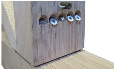
Bild 6-10: Schrauben mit erreichtem Bruchdrehmoment in Träger VG-3.
