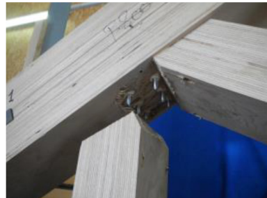
Bild 5-53: Beobachtete Versagensmechanismen von Strahm [50] bei Versuchen an Fachwerkknöten: links : Blockscheren, rechts : Zugversagen der Gewindestangen.
