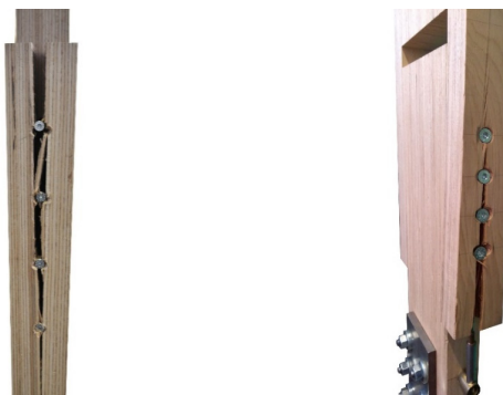
Bild 4-42: Versagte Prüfkörper nach Erreichen der Höchstlast. links: \beta = 0^\circ . rechts: \beta = 90^\circ .
