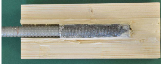
Bild 5-8: Eingeklebte Gewindestange mit zurückversetzter Klebefuge, vgl. [6].
