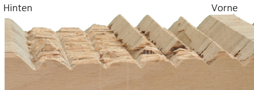
Bild 7-12: Versagensbild der Treppen im Gurtbereich.
