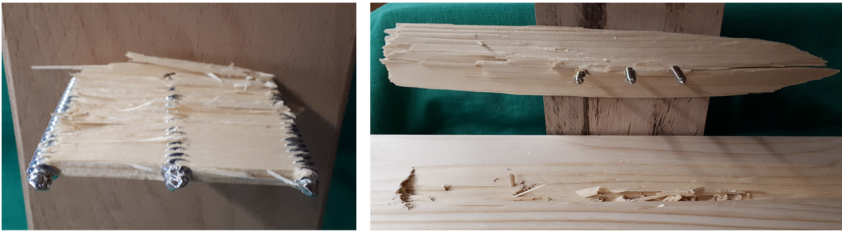
Bild 5-50: Versagte Schraubengruppen nach Erreichen der Höchstlast: Reihenscheren links und Blockscheren rechts , Quelle: [49] .
