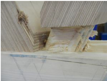
Bild 5-53: Beobachtete Versagensmechanismen von Strahm [50] bei Versuchen an Fachwerkknöten: links : Blockscheren, rechts : Zugversagen der Gewindestangen.
