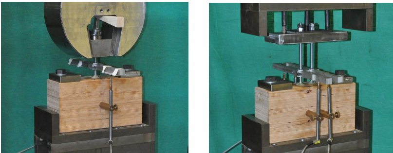
Bild 5-18: Versuchsaufbauten für unter einem Winkel zur Faser eingeklebte Gewindestangen. links : Prüfung einer Gewindestange. rechts : Prüfung einer Gewindestangengruppe.
