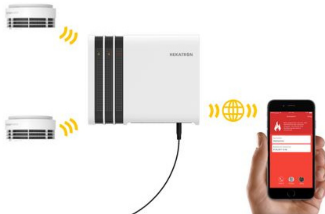
Abbildung 6: Links: funkvernetzte Rauchwarnmelder; Mitte: physisches Gateway als Kopplung zu IoT-Anwendungen beispielsweise auf Smartphone. Zusätzlich besteht eine akustische Schnittstelle (smartsonic) zwischen Rauchwarnmelder und Smartphone (hier nicht dargestellt), über die Daten ausgelesen werden können [29]
