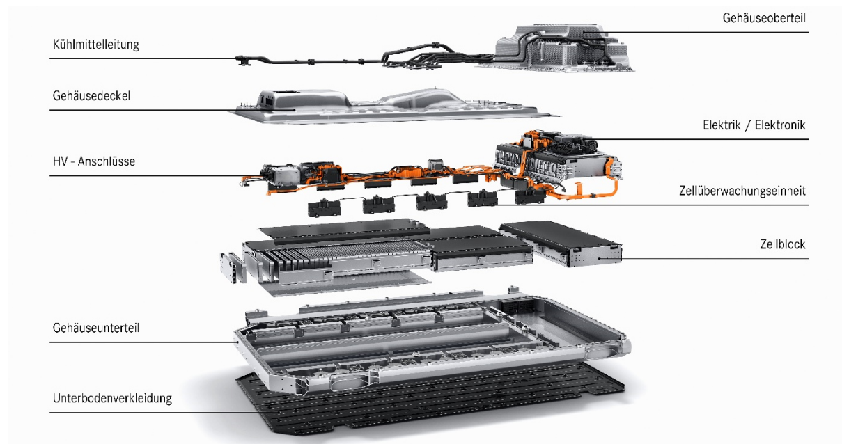
Abbildung 7: Explosionsdarstellung der HV-Traktionsbatterie des Mercedes-Benz EQC [Bildausschnitt aus 30]
