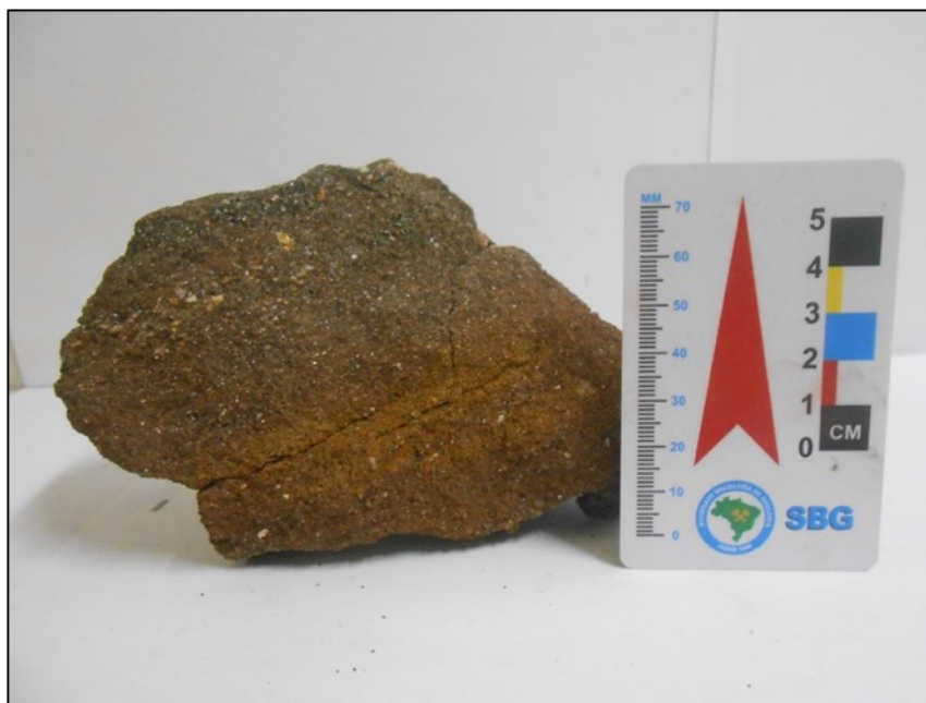
Figura 5.36. Arenito ferruginoso da Formação Pimenteiras. Rocha de coloração roxo-azulada com estratificação plano paralela composta de grãos de quartzo do tamanho areia média a grossa.
