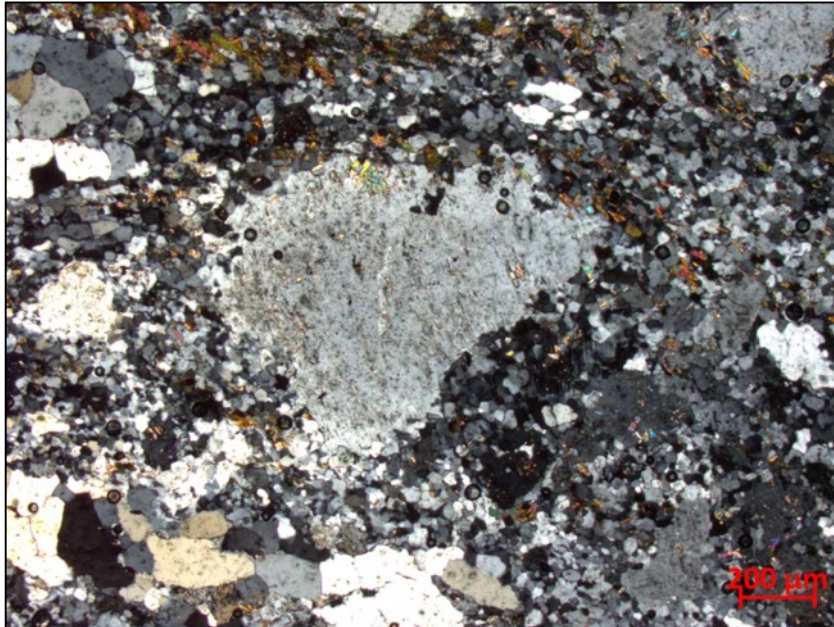
Figura 5.51. Fotomicrografia do Domínio I: Porfiroclastos de plagioclásio. Notar a estrutura manto-núcleo.
