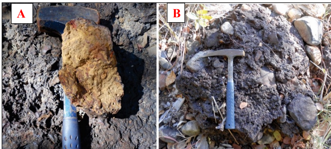
Figura 5.38. A) Crosta vermiforme amarela com canais preenchidos por material argiloso amarelo; B) Crosta conglomerática com clastos arredondados de diferentes tamanhos.
