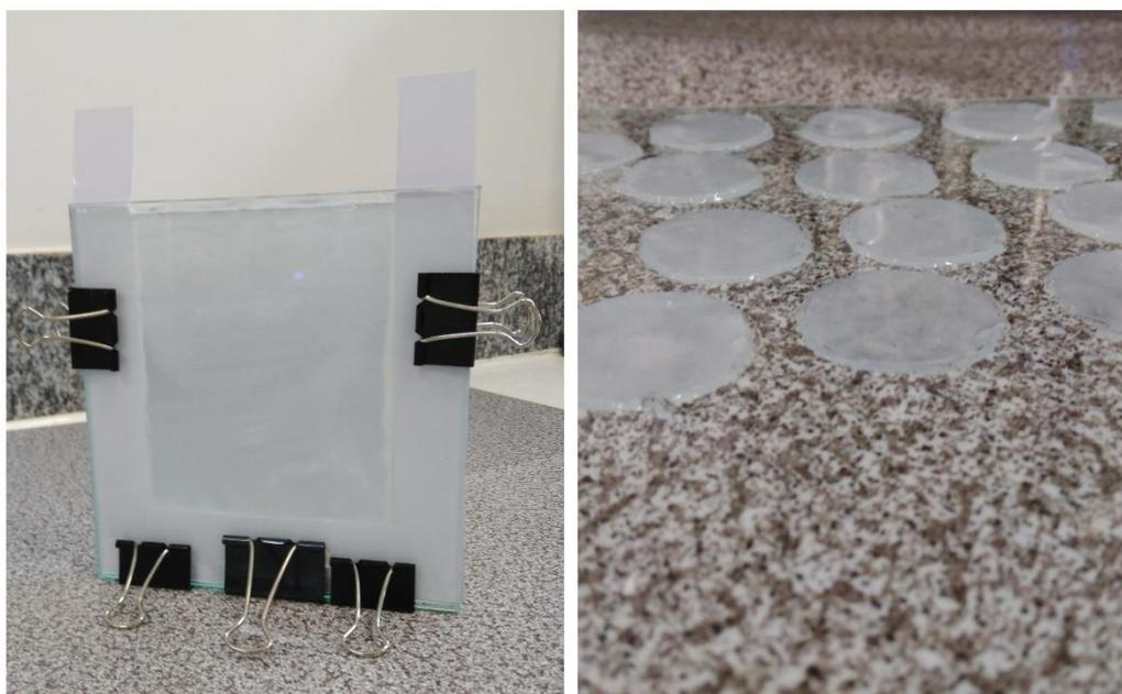
Figura 4 GL-HMIP entre as placas de vidro; discos ligantes destacados.
