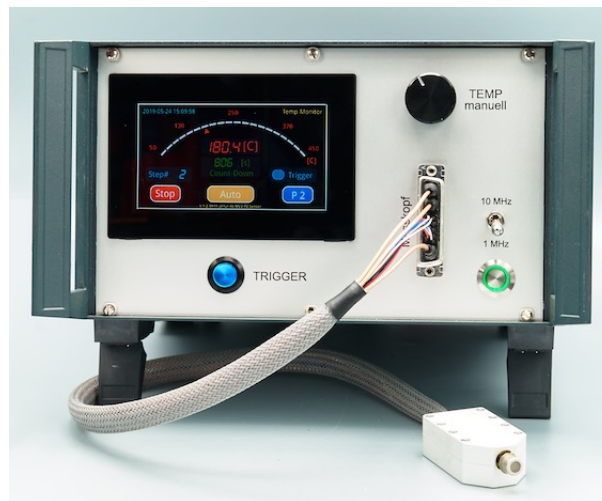
Abb. 5.4.3 Der im Gehäuse integrierte Prototyp des Messsystems, hier bestückt mit dem LF-Modul, der SoC-Baugruppe, dem Interface-Modul und dem Temperaturcontroller. Im Vordergrund erkennt man den Messkopf mit aufgestecktem Sensor.
