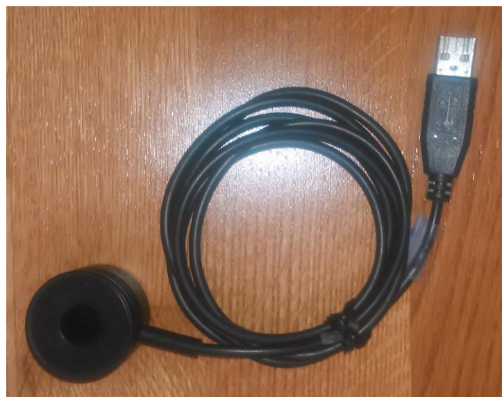
Kuva 8. Tietokoneen ja mittarin väliseen tiedonsiirtoon tarvittava USB-liitännäinen optinen-lukija
