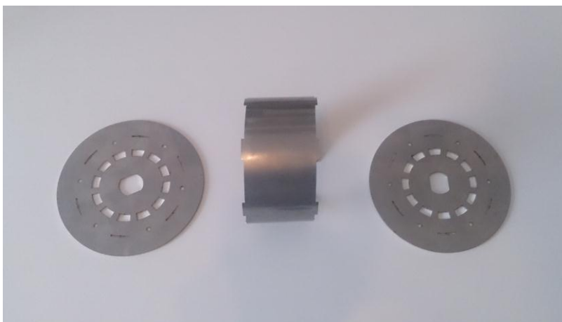
KUVA 23. Kela varten valmistetut osat.
