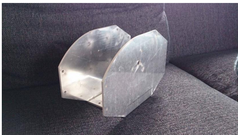
KUVA 15. Vesileikattu ja taivutettu runko.
