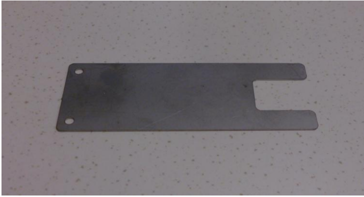
KUVA 22. Laserleikattu kosketusnäytön kiinnike.
