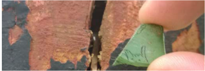
Kuva 16: Albionin rungon peräpäähän halkeamasta löydetty kumipala.
