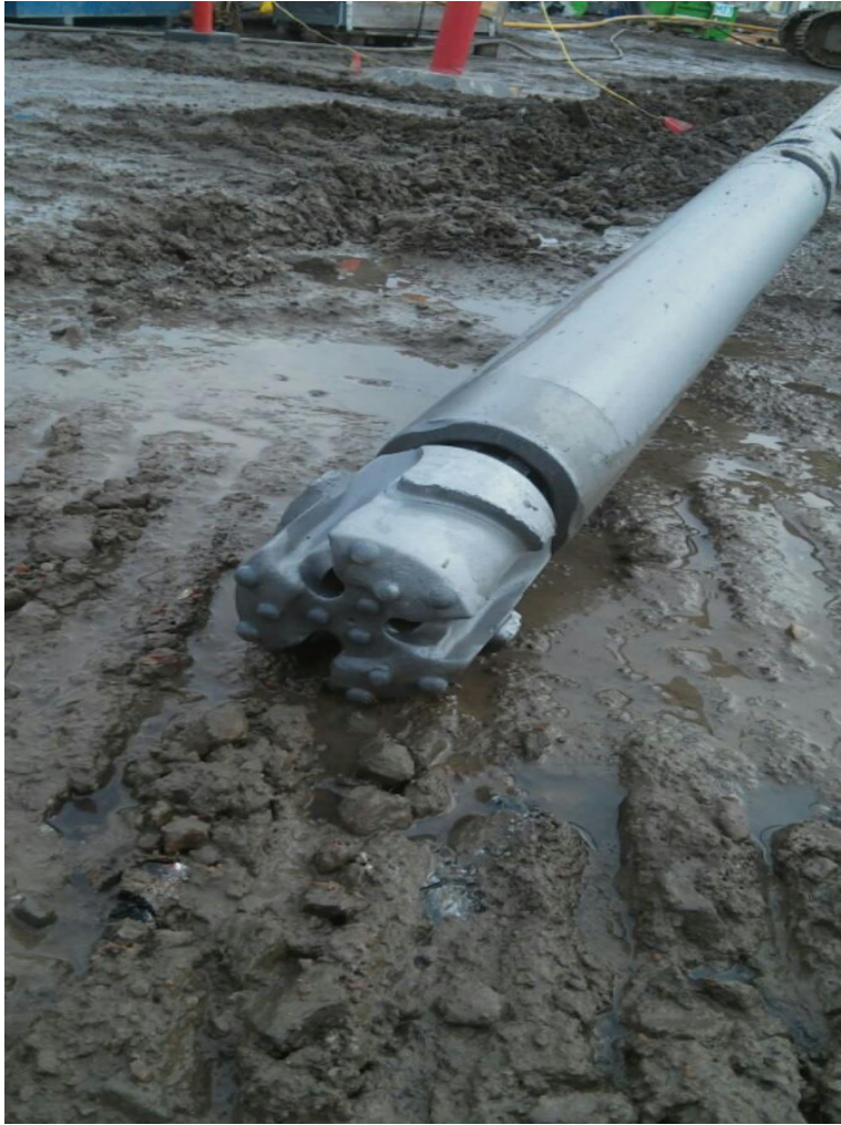
KUVA 8. Pilottikruunu kiinnitettynä uppovasaraan
