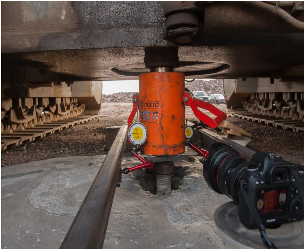
KUVA 12. Koekuormitustunkki nosturin alla. Kuormituksen alaisena mikropaalu (Arend Oudman, 2015)
