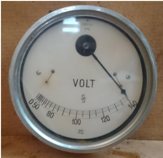
Kuva 10. Kiinteistön alkuperäinen jännitemittari generaattorissa.
