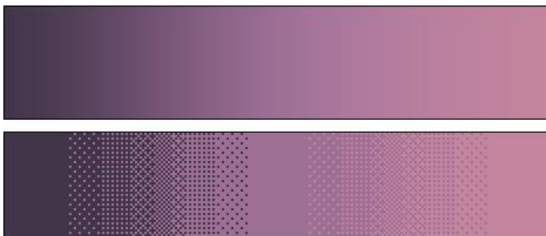
Kuva 13. Ylhäällä oleva väriliukuma on tehty PhotoShopissa ja sisältää lukuisan määrän värejä. Alempi liukuma on tehty käyttämällä dithering-tekniikkaa ja siinä on vain kolme eri väriä (Makegames 2009).
