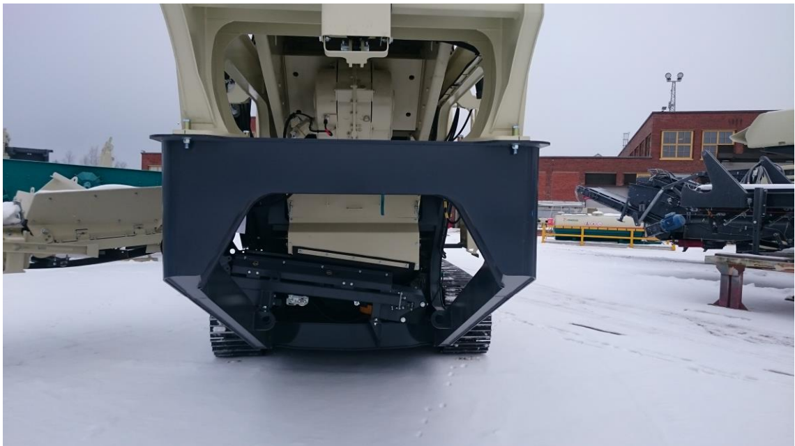
KUVA 17. Uusi runko syöttimen puolelta (Kuva: Marko Santala 2016)
