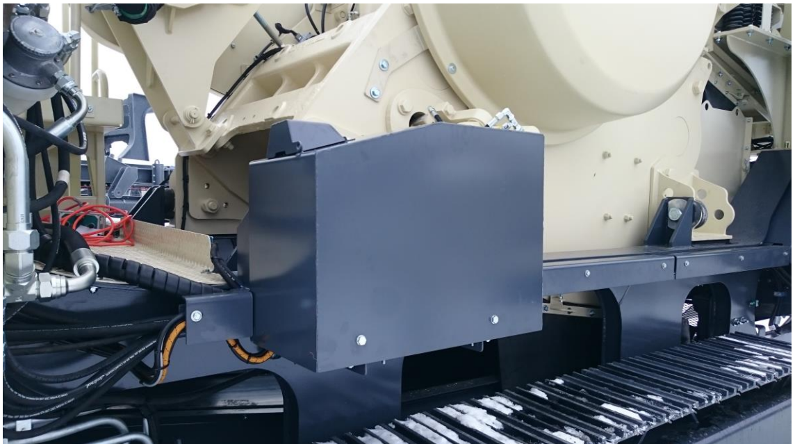
KUVA 19. Ureasäiliö ja suoristettu letkuhylly (Kuva: Marko Santala 2016)
