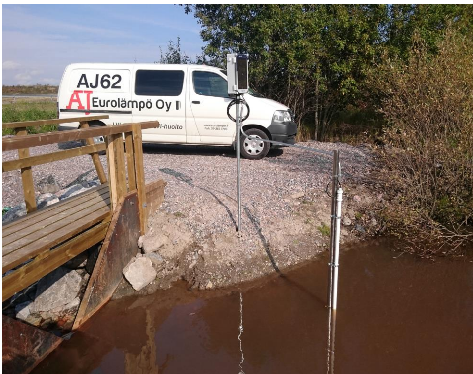
Kuva 12. Ojaan asennettu automatisoitu mittapato.
