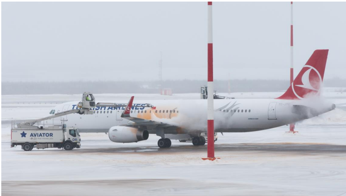
Kuva 1. Turkish Airlinesin Airbus A321 jäänpoisto- ja -estokäsittelyssä asemataso kahdeksan etäjäänpoistoalueella 13.1.2016.
