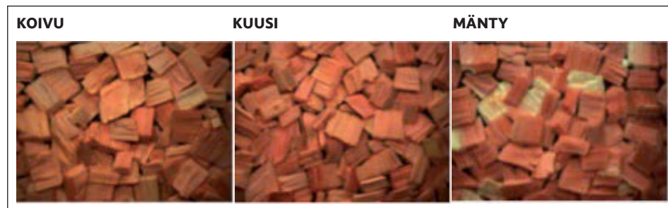
KUVA 4.3.1. Spektrikuvantavilla mittalaitteilla kuvatut koivu, kuusi- ja mäntyhakenäytteet. Huomaa fluoresoivia ”kellertäviä” hakekomponentteja männyn hakekuvassa oikealla.
