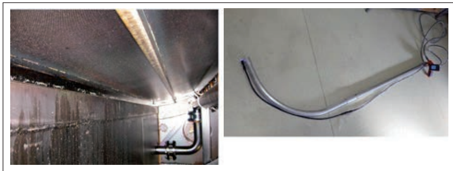
KUVA 5.4.2. DD-pesuri sekä pesurin saostuman mittaamiseen kehitetty laitteisto.
