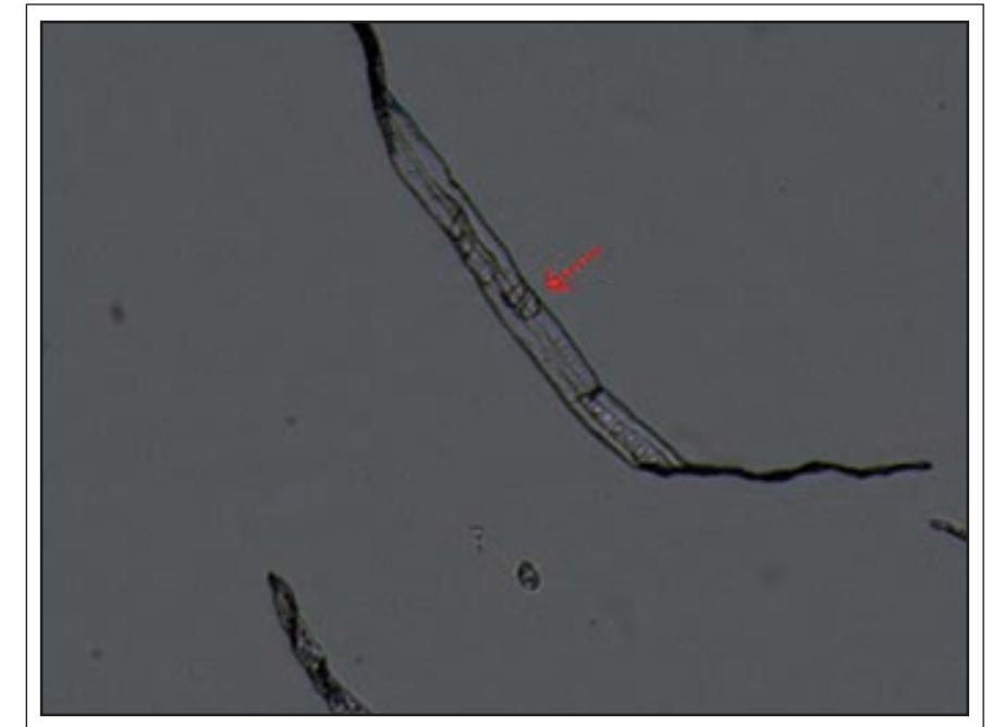
KUVA 4.2.1 Männyn kuidussa erottuvat ikkunamaiset rakenteet, joita kuusen kuiduissa ei ole.
