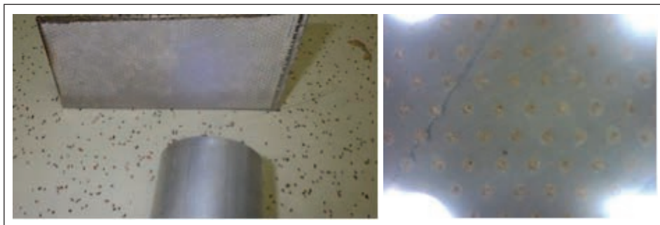
KUVA 5.4.3. Pesurin sihtilevy sekä kuvauspää (vas.) ja esimerkki laitteistolla saatavasta kuvadatasta.
