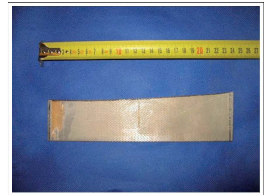
KUVA 5.4.1. Näytepala saostuman tukkimasta DD-pesurin sihtilevystä.
