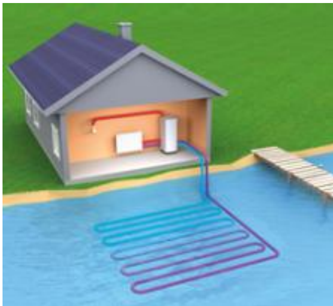
Kuva 7 Lämmönkeruupiiri vesistössä (Suomen Uusiutuva Energia Oy, 2010)
