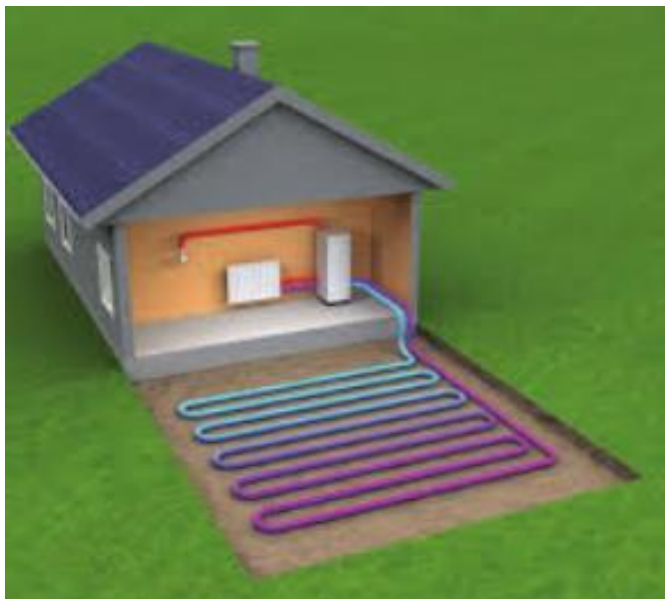
Kuva 6 Lämmönkeruupiiri maassa (Suomen Uusiutuva Energia Oy, 2010)
