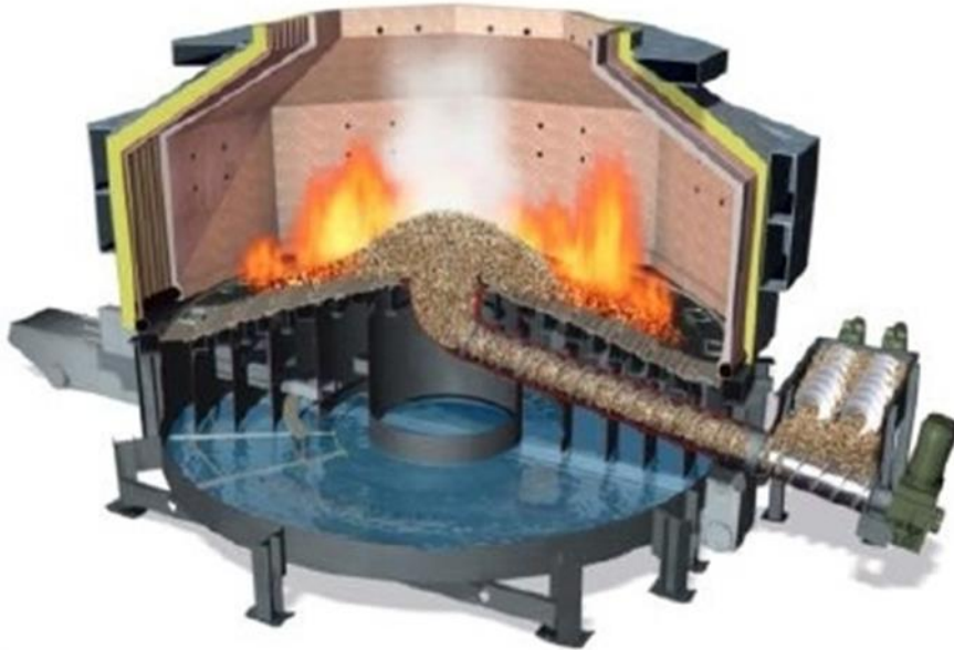
Kuva 10: Karhulan biolämpökeskuksen periaatekuva. (3.)
