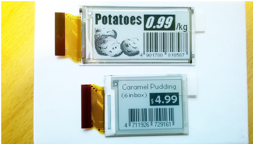
Kuvio 28: Kaksi e-paperi demoa, kuva säilyy vaikka näytöt on irrotettu ohjaimesta. Viivakoodin pystyy lukemaan ongelmitta.
