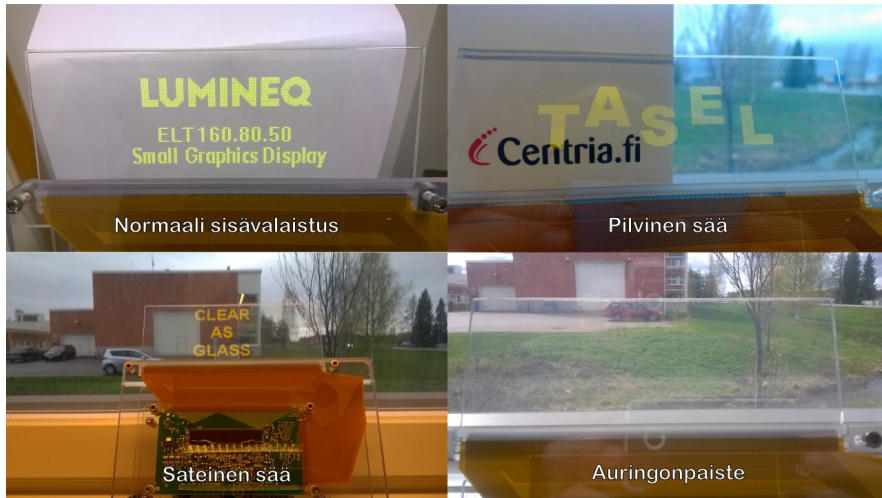
Kuvio 34: ELT 160.80.50 toimii erinomaisesti sisällä. Auringonpaisteissa kuva on liian himmeä, mutta pilvisellä ja sateisella säällä näyttö toimii hyvin.
