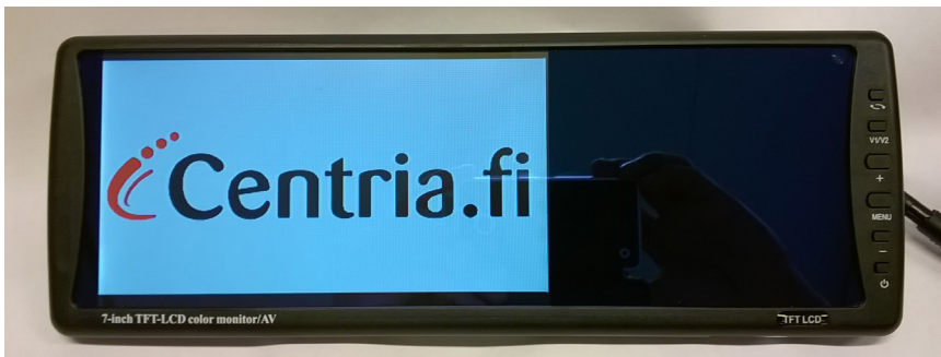
Kuvio 40. Muutama viikko testien jälkeen tilalle saatiin ehjä näyttö. Kuvasta on nähtävissä, että oikea reuna on aina peilikäytössä.
