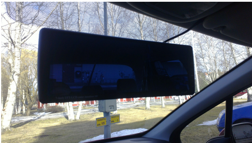
Kuvio 38. Peilinäyttö asennettu alkuperäisen peruutuspeilin päälle.
