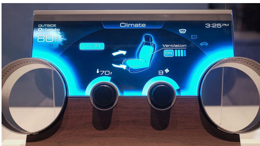
Kuvio 22: Demossa näyttö on upotettu auton paneeliin. Vapaamuototekniikka mahdollistaa ohjausnappien upottamisen osittain näyttöön (Teemu Hynninen 2015, [47]).
