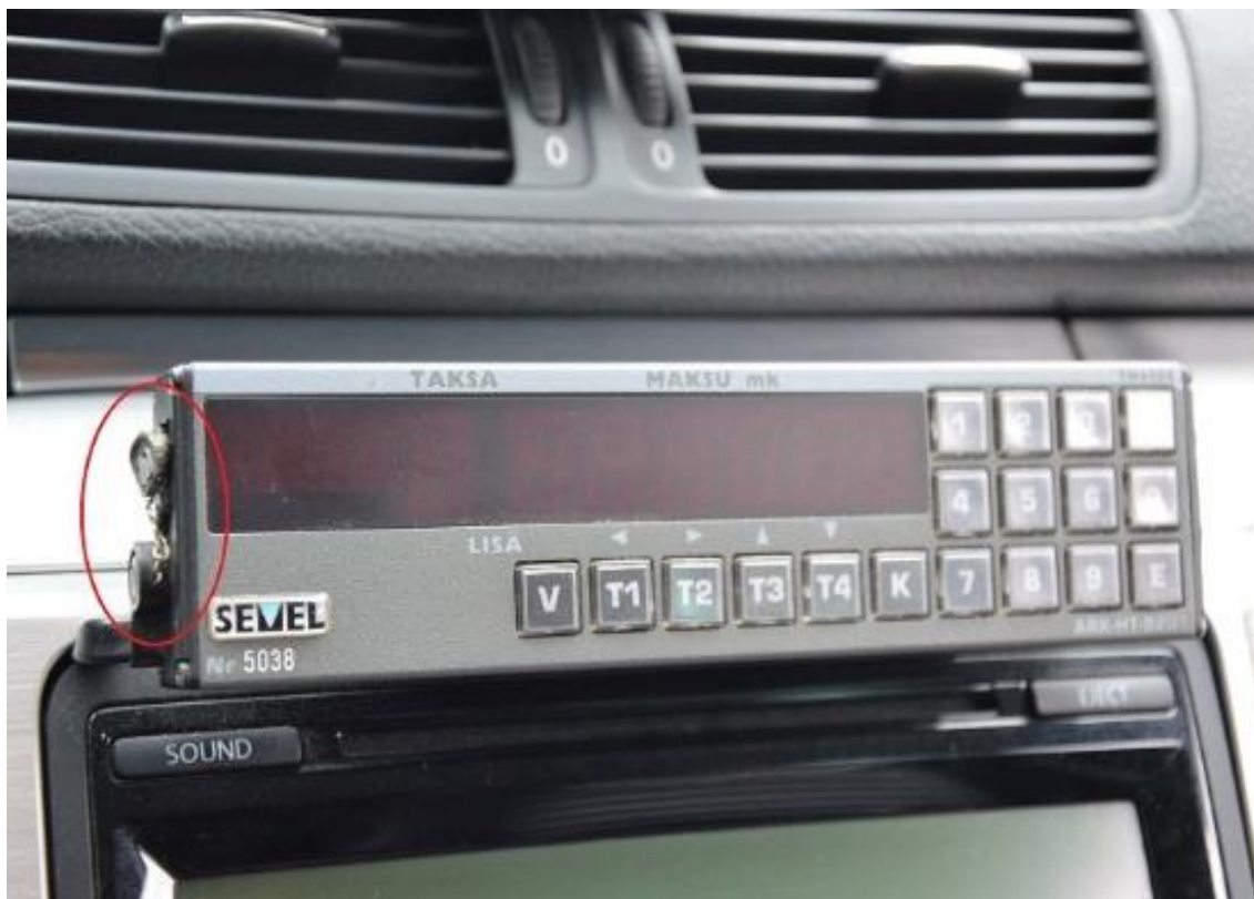
Kuva 2: Taksamittari, josta sinetti on ympyröity
