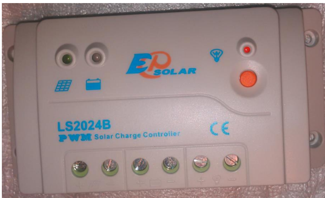
Kuva 16 Lataussäädin mallia EPsolar LS2024B
