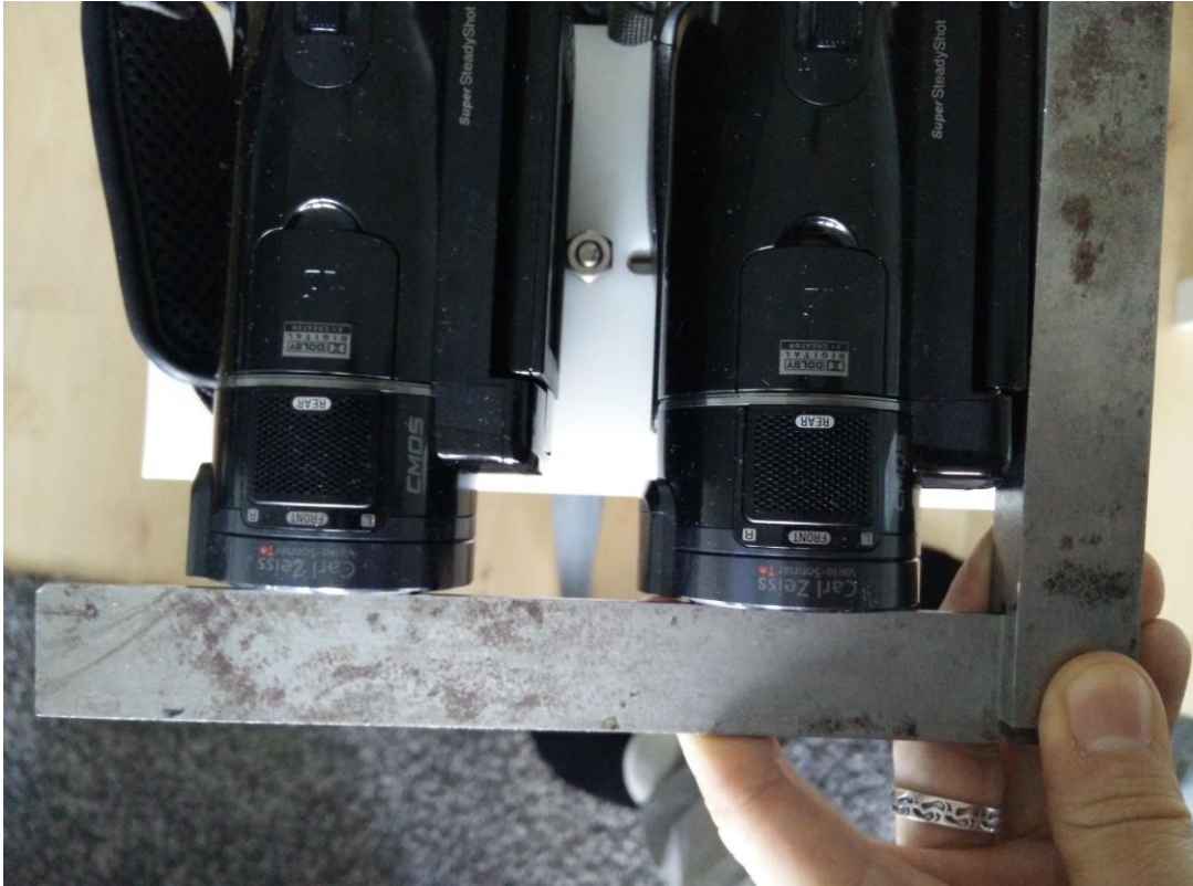
Figur 10. En vinkelhake används för att garantera att kamerornas linser är i exakt samma vinkel. Illustrerat hur snett det blir med en hand.
