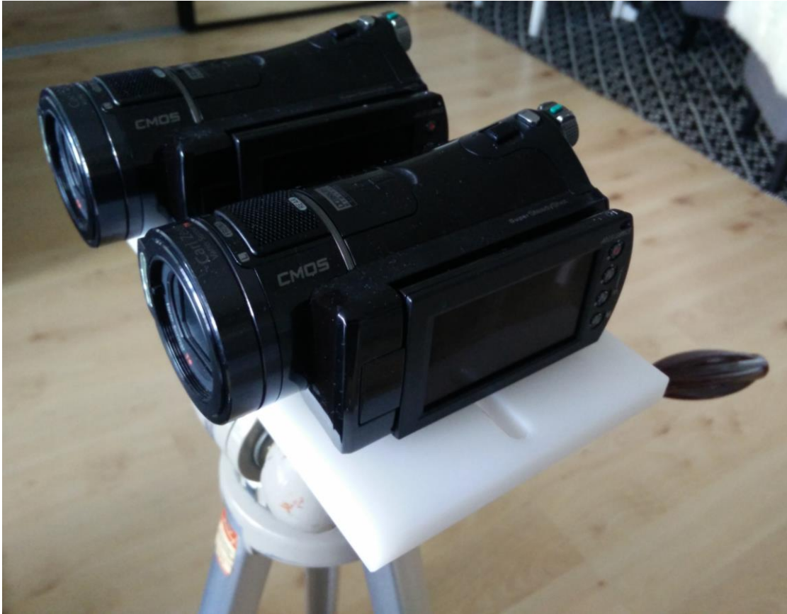
Figur 8. Kamerorna fästa på riggen, riggen fäst på ett stativ.
