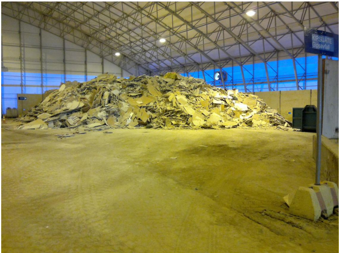
Kuva 3. Kipsilevyjätteen vastaanotto- ja varastointialue PIMA-hallissa Ämmässuolla
