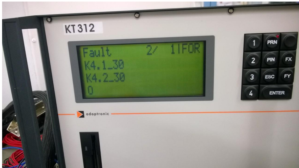
KUVA 3. Testausohjelma ilmoittaa virheelliset yhteydet
