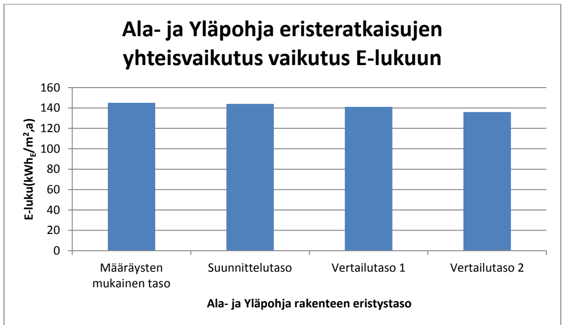
Kuva 4. Ala- ja yläpohjarakenteen eristevahvuuden vaikutus E-lukuun
