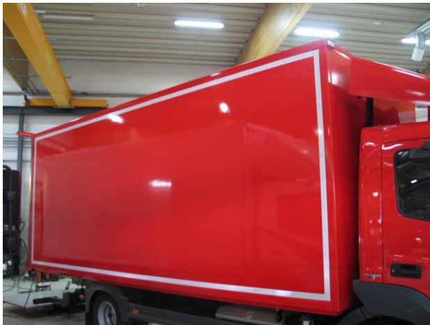
KUVA 9. Yhtenäinen ääriiviivamerkintä sivulla (Fokor Oy 2015)
