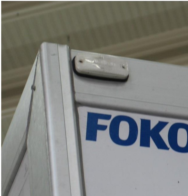
KUVA 4. Esimerkki äärivalaisimen asettelusta edessä (Fokor Oy 2015)
