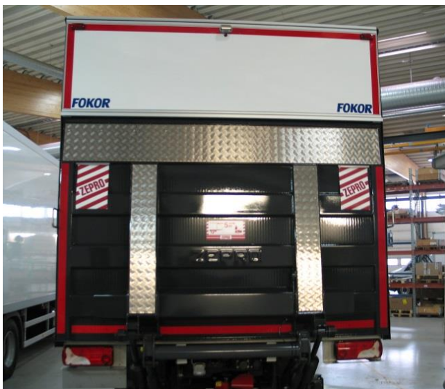
KUVA 10. Ääriiviivamerkintä takana (Fokor Oy 2015)
