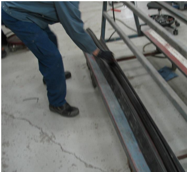
KUVA 14. Saippualiuoksen levitys tiivisteeseen (Fokor 2015)
