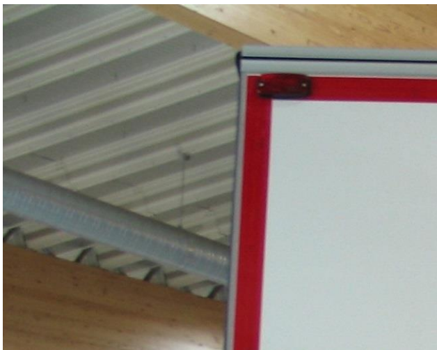
KUVA 5. Esimerkki äärivalaisimen asettelusta takana (Fokor Oy 2015)
