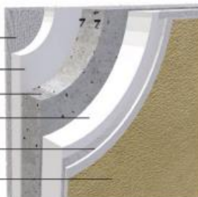
Kuvio 1. Eps-betonielementin rakenne.
