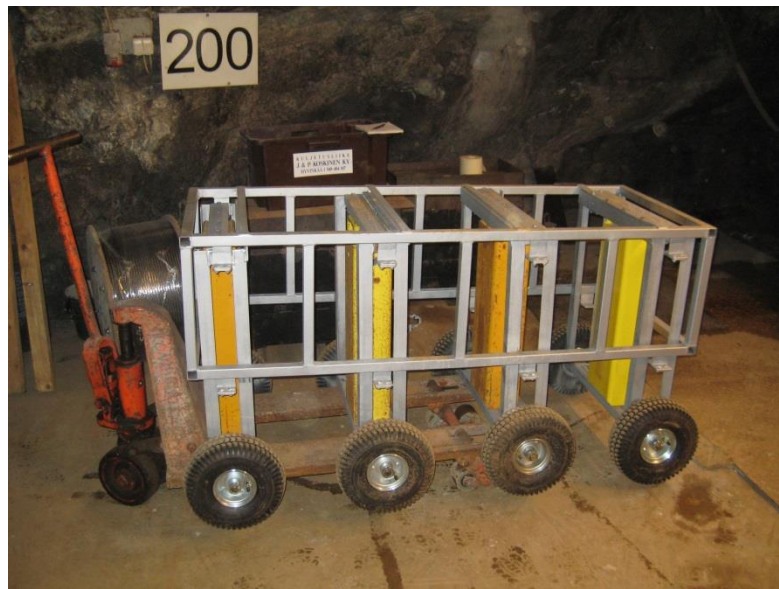
KUVA 12. Rullakon siirtelyyn käytettiin pumppukärryä. Jokaisella akselilla on yksi 80 kg testipaino
