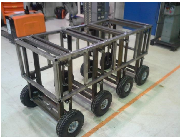
KUVA 11. Kuormamuutokseen käytetty rullakko
