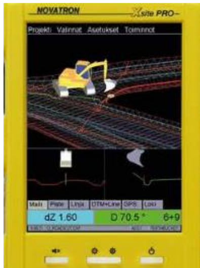
Kuva 2. Esimerkki kaivinkoneen kuljettajalle näkyvästä näyttöpäätteestä, malli on Novatronin Xsite PRO. Ylemmässä kuvassa näkyy kaivinkoneen sijainti suhteessa suunnitelma-aineistoon, alapuolella on ruudut kauhan sijainnin hahmottamiseksi. Lukuarvon näytön alalaidassa osoittavat etäisyyden suunniteltuun tasoon nähden. [28.]
