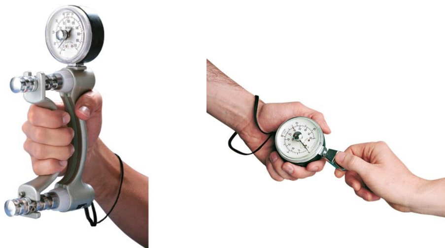
KUVA 11. Puristusotteen ja pinsetti/avainotteen voimannmittaus (Camp Scandinavia OY, 2014)
