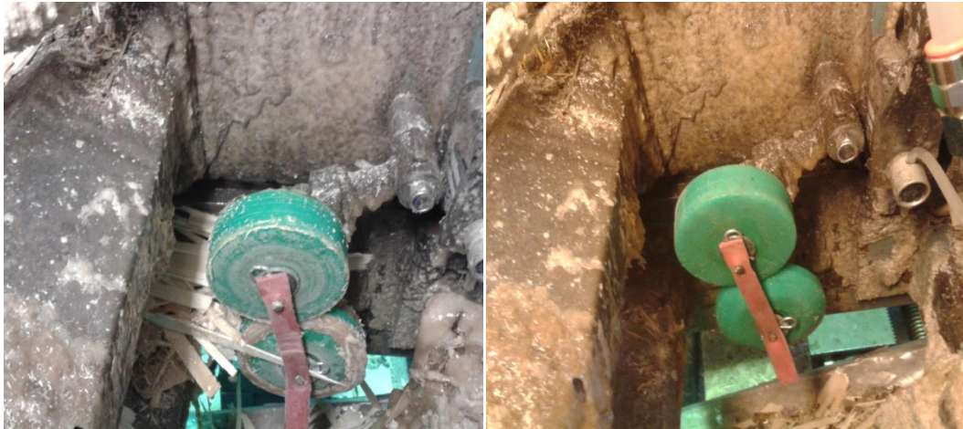
Kuvat 3 ja 4. Liimanlevitysrullat, likainen ja puhdas
