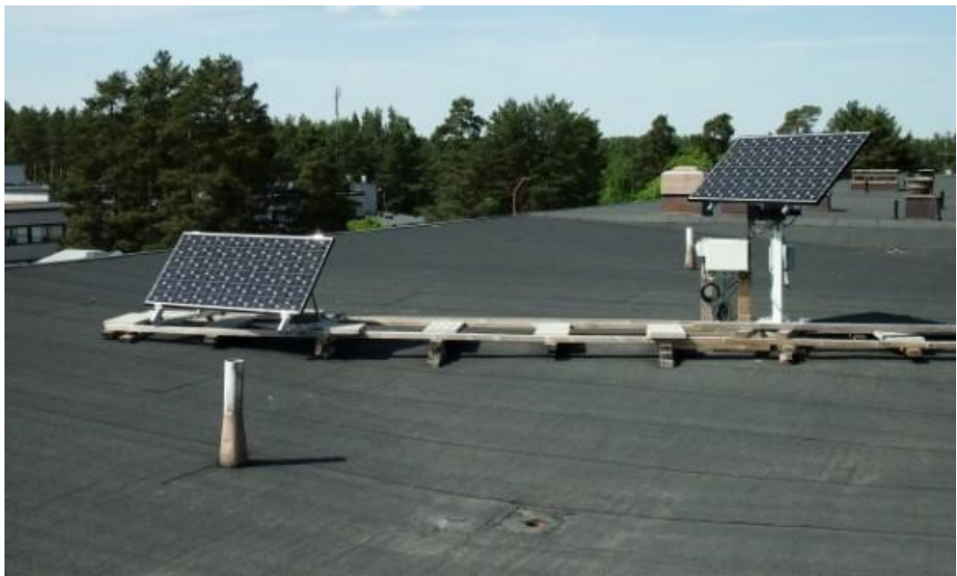
KUVA 4. SAMKin testilaitteisto, jossa kääntyvä tracer ja sen vertailupaneeli (SAMK 2014).
