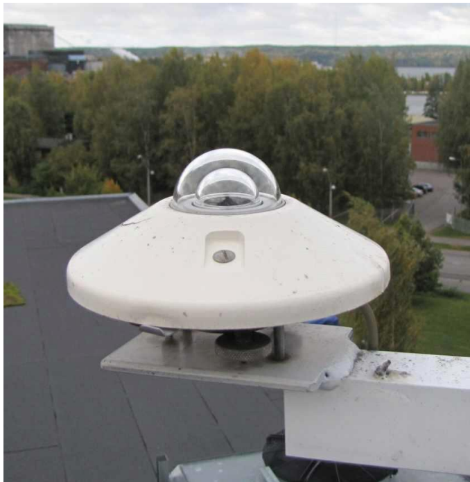
KUVA 10. Helsingin yliopiston sääasemaan liitetty Kipp & Zonen CM 6B pyranometri Niemenkadun kampuksen C-siiven katolla.
