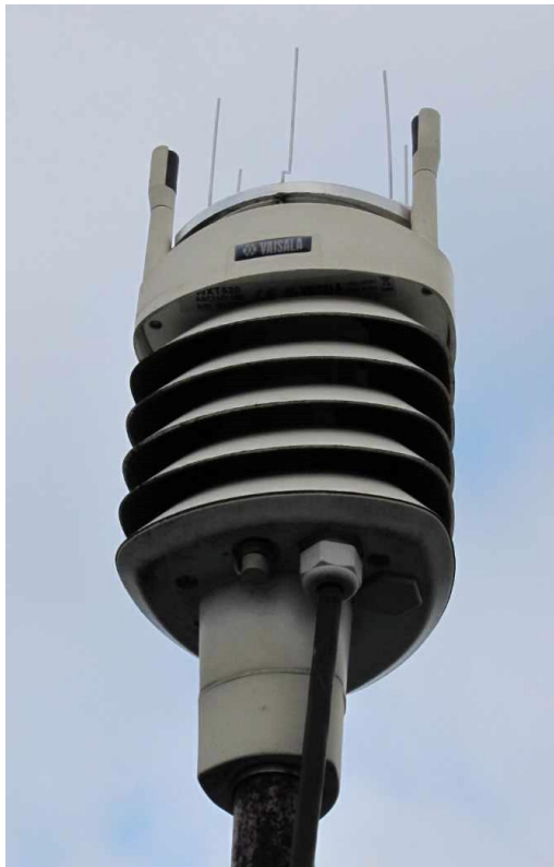
KUVA 9. Niemenkadun kampuksen C-siiven katolla oleva Helsingin yliopiston sääaseman Vaisala WXT520 -säälähetin.
