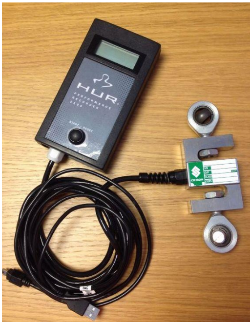
Kuvio 5. Polven koukistus- ja ojennuslaitteeseen kiinnitettävä voima-anturi sekä digitaalinen näyttölaite (Alkuperäisen kuvan ottanut: Riikka Talja 2014.)
