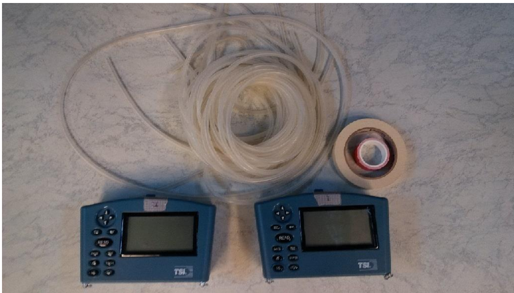
Kuva 10: Mittalaitteet: Mikromanometrit ja ilmaletkua. Kiinnityksessä käytettiin kaksipuolista teippiä ja maalarinteippiä.
