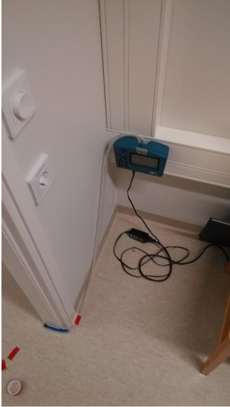
Kuva 14: Toinen mikromanometri ryhmän 2 varastohuoneessa. Ilmaletkut vietiin ryhmän 2 ja 1 eteisiin varastohuoneen oven alta.
