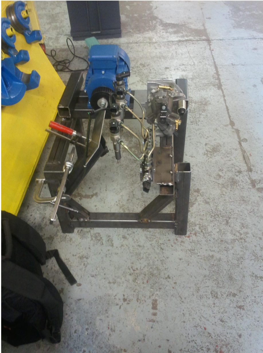
Kuva 4. Suutintelineen korkeuden mitoittaminen puristimien avulla
