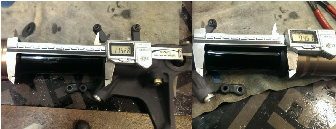
KUVA 8. Vakiomittainen ja lyhennetty KYB-keulaiskunvaimennin
