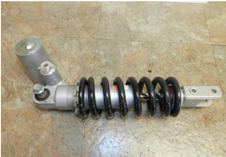
KUVA 5. Hayabusan takaiskunvaimennin, jousi ja pikasäätö-clickerit
