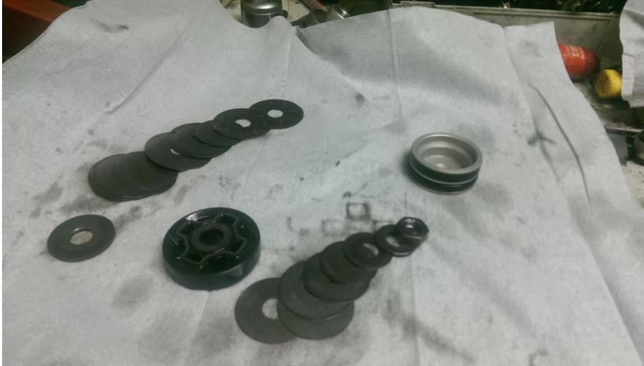
KUVA 4. Takaiskunvaimentimen shimmilevyt ja mäntä
