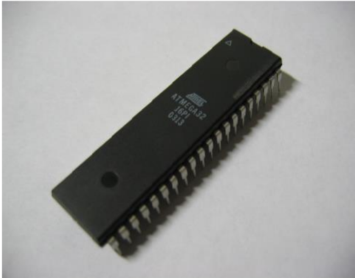
Kuvio 7. Esimerkki mikrokontrollerista (Mikrokontrolleri [Viitattu 4.4.2014]).
