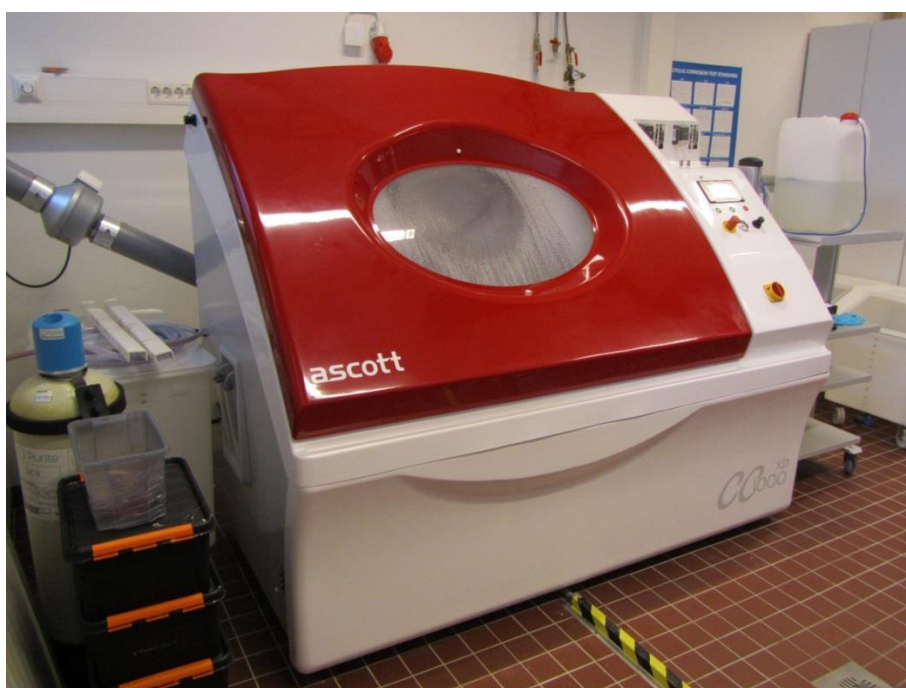
Kuva 13 Testeissä käytetty Lapin ammattikorkeakoulun suolasumukaappi Ascott CC 1000 XP. Kuvassa oikealla näkyvässä säiliössä kalsiumkloridiliuosta, jota suihkutettiin suuttimista korroosiotestauksessa hihnapyörien päälle.
