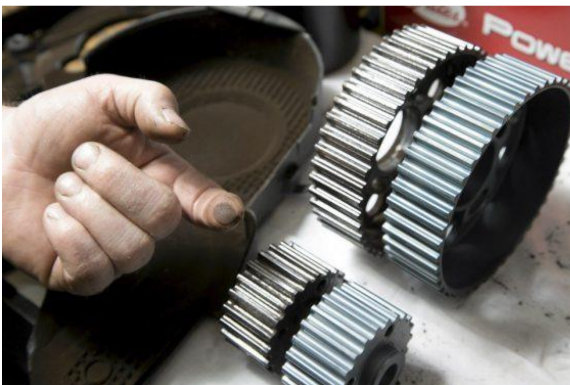
Kuva 31 Kuluneet ja uudet hammashihnapyörät vierekkäin (Hs10.snstatic:n www-sivut, hakupäivä 24.5.2014.)
