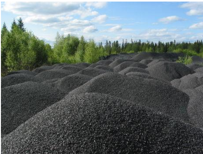
Kuva 8 Tornion terästehtaalla sivutuotteena syntyvä OKTO-murske (Lapin Kansan www-sivut, hakupäivä 23.4.2014.)
