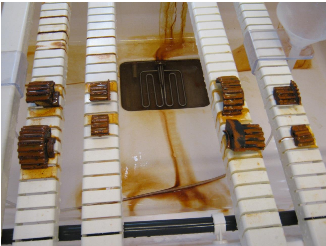
Kuva 24 Hihnapyörät suolasumutestissä 6. päivän jälkeen
