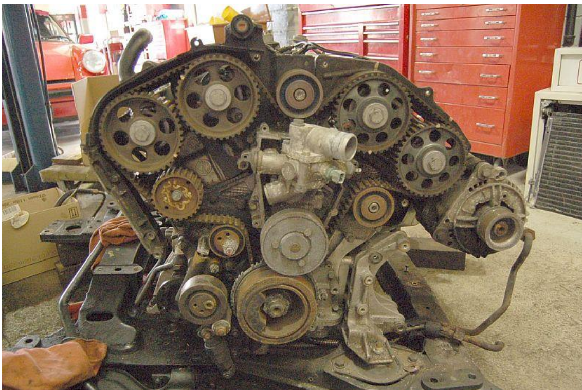
Kuva 4 Hammashihna V8 doch mallisessa moottorissa (Alfabb:n www-sivut, hakupäivä 1.4.2014.)
