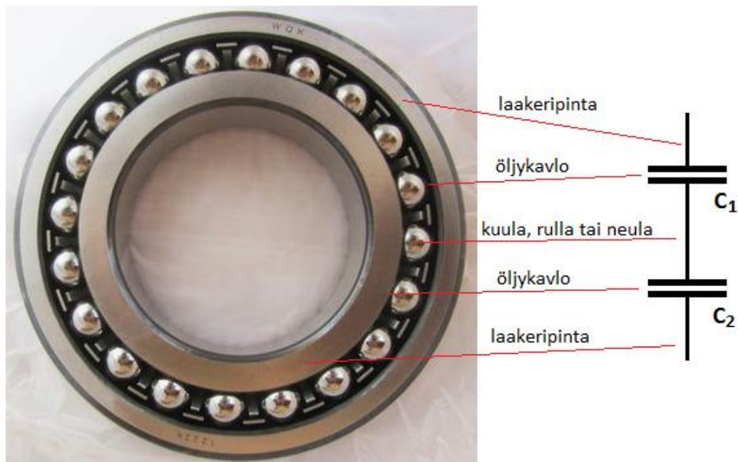
Kuva 2. Laakerin sähkötekniinen rakenne (Directindustry 2014, kuvaa muokattu)
