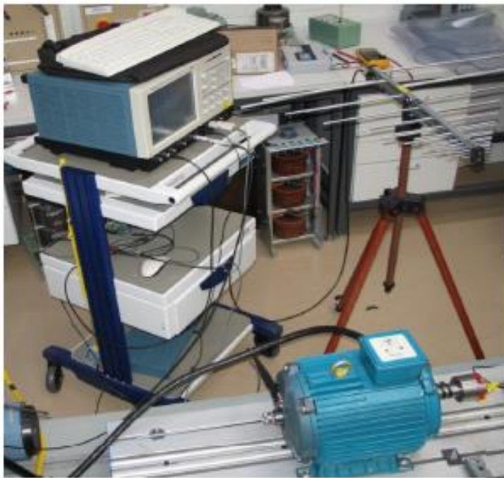
Kuva 31. Laakerikipinöinnin mittauslaitteisto (Ahola 2011)
