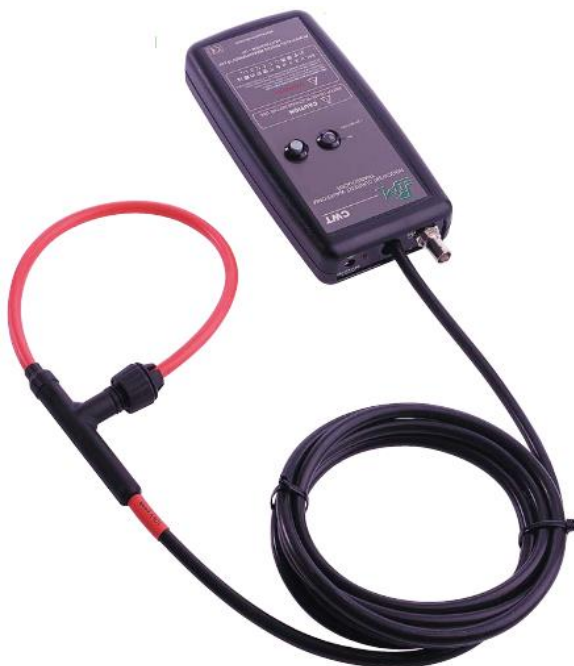
Kuva 25. Mittauksessa käytetty PEM CWT1-Rogowskin kela (PEM 2010)
