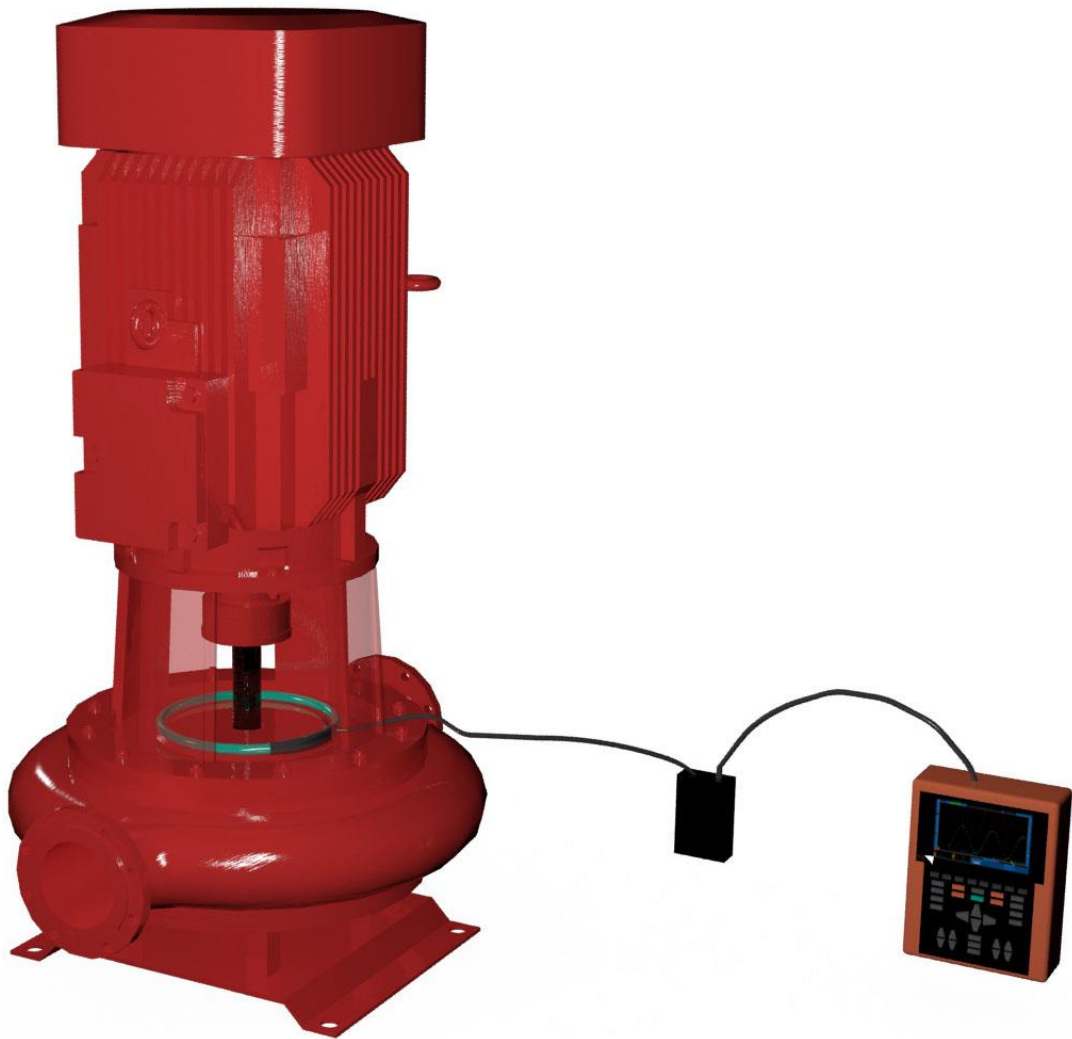
Liite 1. Akselinmaadoitusvirran mittausperiaate
