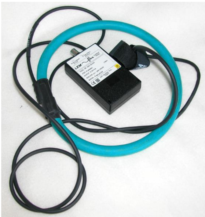
Kuva 18. Mittauksessa käytetty LEM flex RR300-SD/24 -virta-anturi
