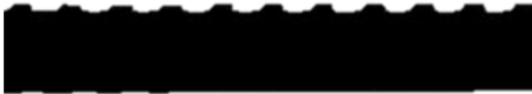
Kuva 9. Yksittäinen siluettikuva harjaterästangosta.
