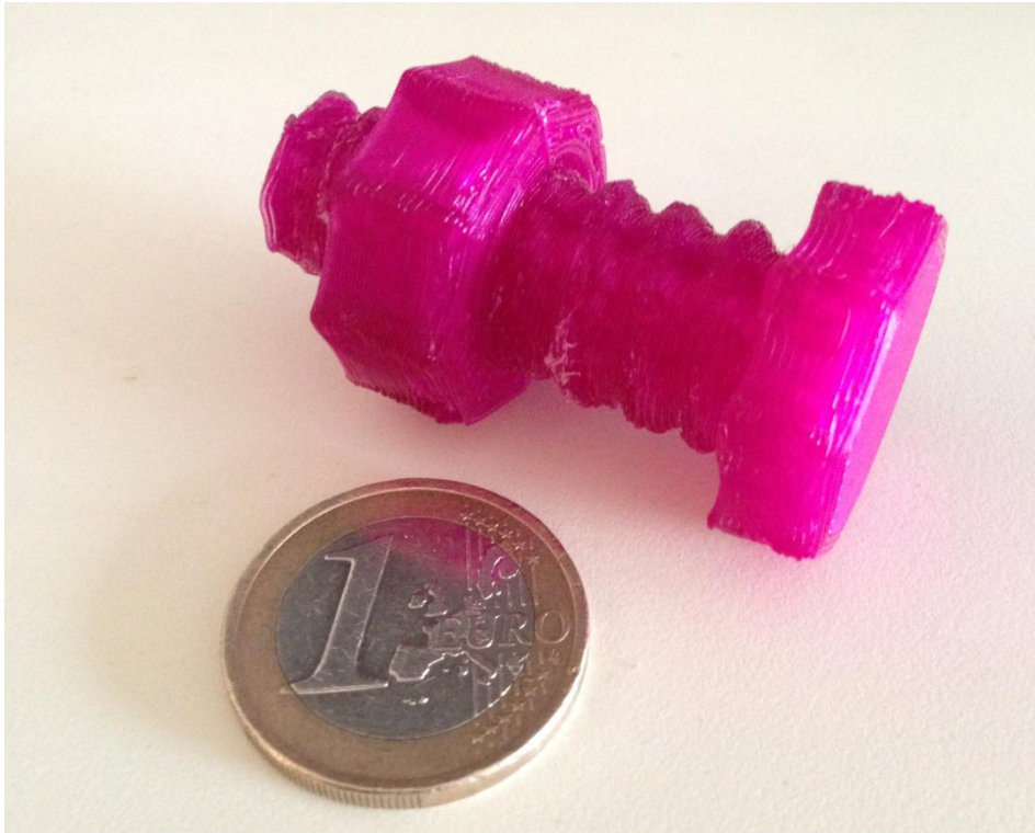
Figur 10. Den färdiga bulten och muttern. Aningen grov yta blev det, men gångorna funkar.
