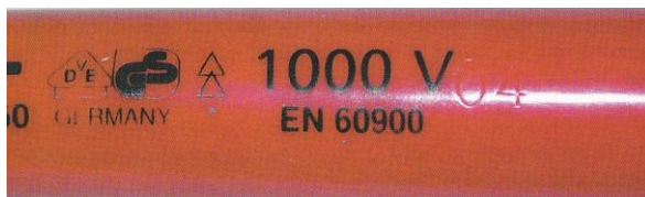
Kuva 7. Jännitetyökalun standardin SFS-EN 60900 mukainen merkintä (Mäkinen 2010, 20).
