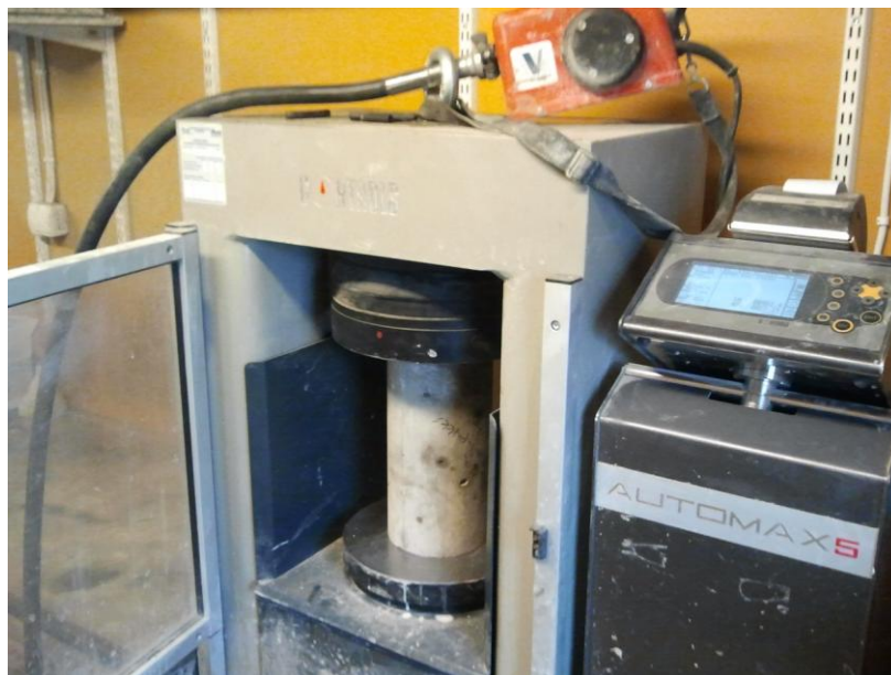
Kuva 8. Puristuslujuuden mittaaminen lieriöpalkista
