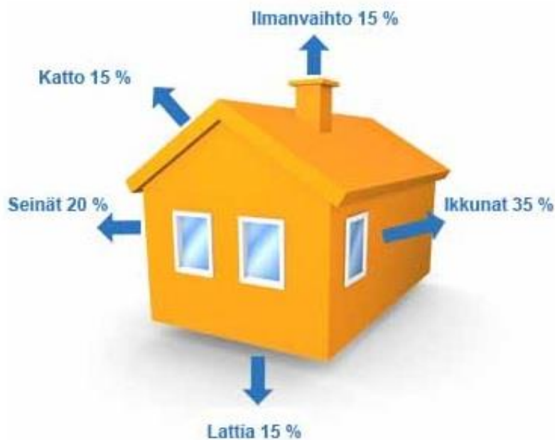
Kuva 4. Lämmön siirtyminen talosta ulos [5.]
