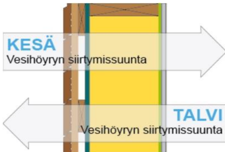
Kuvio 3. Konvektio vuodenaikojen mukaan. Vuodenaikojen vaihtelevat ilmanpaine-erot vaikuttavat konvektion kulkusuuntaan. /14/
